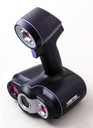
Izquierda: escáner Go!Scan 50 de luz estructurada usado para la digitalización 3D de este retrato.
