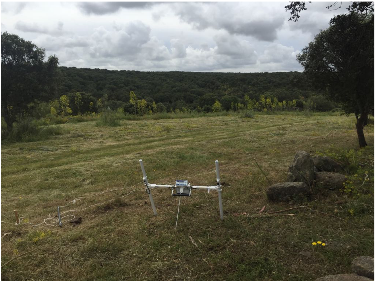
Equipo de prospección geomagnética.
